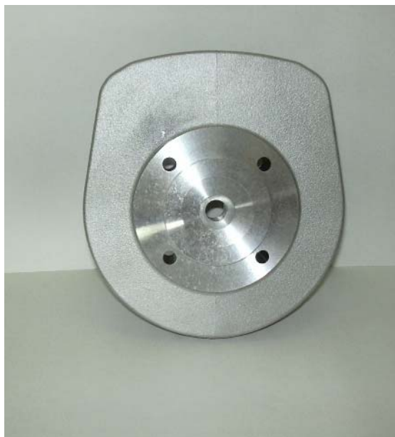
FOTO DELLA CAMERA DI COMBUSTIONE
